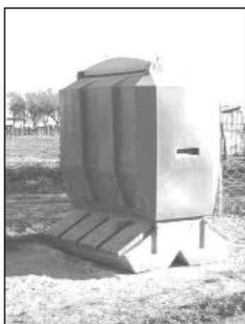
Figura 10. Comedero con fluido por gravedad de plástico.
